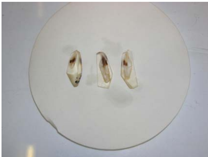
Obr. 51: Uříznuté chipy o síle cca 1 mm určené k broušení.
