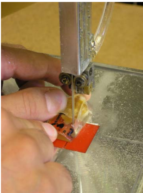
Obr. 50: Řezání diamantovým pásem s vodním chlazením.
