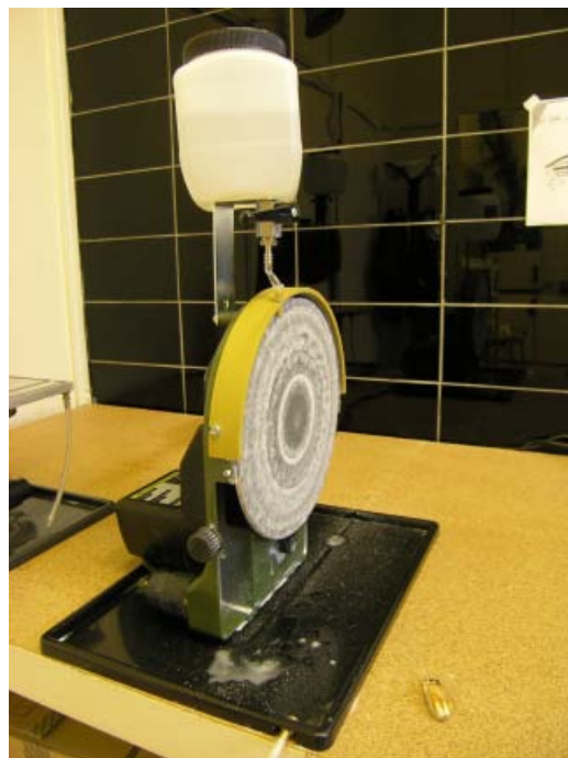
Obr. 52: Čelní kotoučová bruska Proxxon TG 250/E, která byla používána k základnímu broušení chipů brusným papírem zrnitosti 320 s použitím vodního chlazení.
