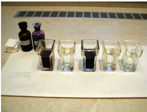
Obr. 63: Preparáty byly barveny různými metodami – zde sada kyvet pro barvení alizarinovou červení a toluidinovou modří.
