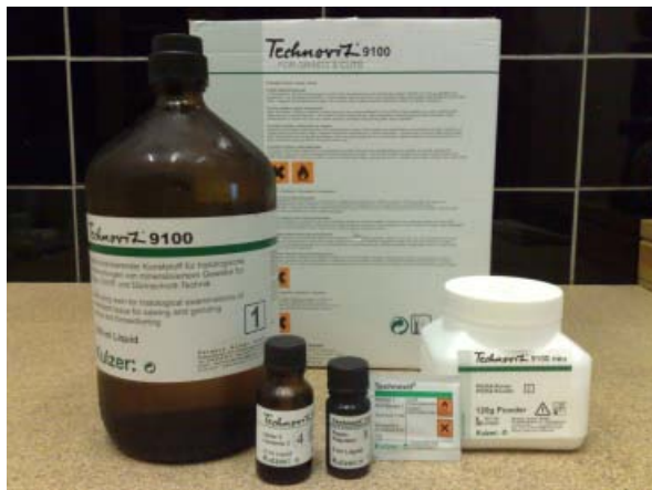
Obr. 41: Technovit 9100 New byl použit jako zalévací médium.
